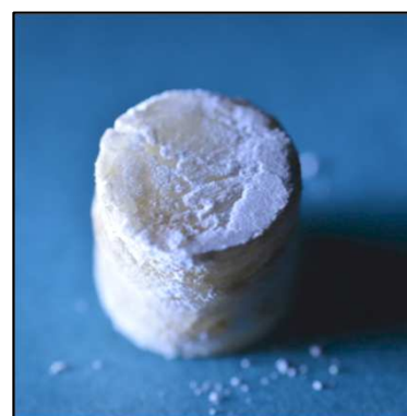
Echantillon dense obtenu à partir de poudre d'amidon de maïs cireux par compression- frittage à ultrasons
