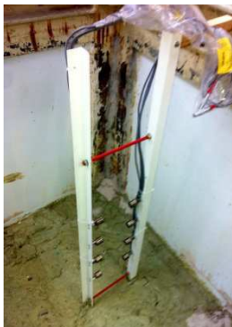
Echelle de Bender elements pour mesure de référence des vitesses de propagation des ondes dans le sol
